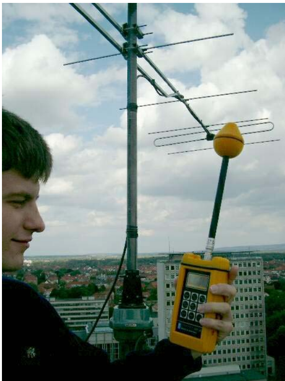
Bild 2: EMR-300 während der Messung des elektrischen Feldes unter einer Richtantenne für 144 MHz.
