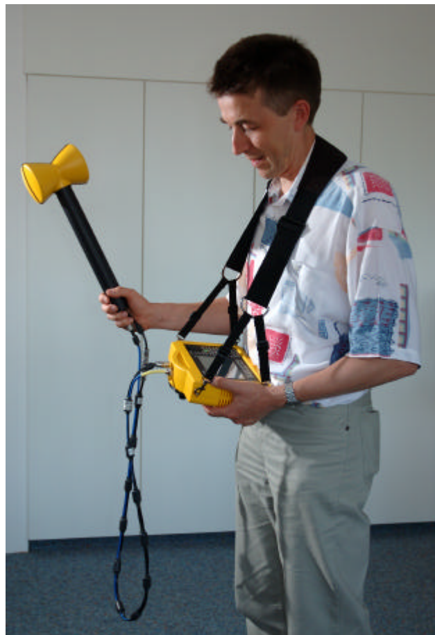
Bild 2: Das Selective Radiation Meter SRM-3000 mit uniaxialer Antenne und „Maximum Hold“-Funktion, eingesetzt für die Schwenkmethode.
