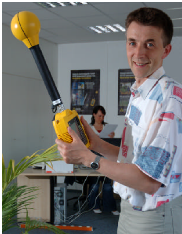
Bild 1: Das Selective Radiation Meter SRM-3000 mit aufgesteckter isotroper Antenne eignet sich für die Abtastung des Raumes ohne Drehen und Schwenken.
