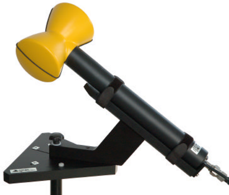
Bild 3: Die uniaxiale Antenne auf einer Drehvorrichtung. Aus Einzelmessungen in drei definierten Positionen errechnet das Messgerät automatisch das isotrope Ergebnis. Entscheidend für die Genauigkeit ist eine geringe Elliptizität der Richtcharakteristik.
