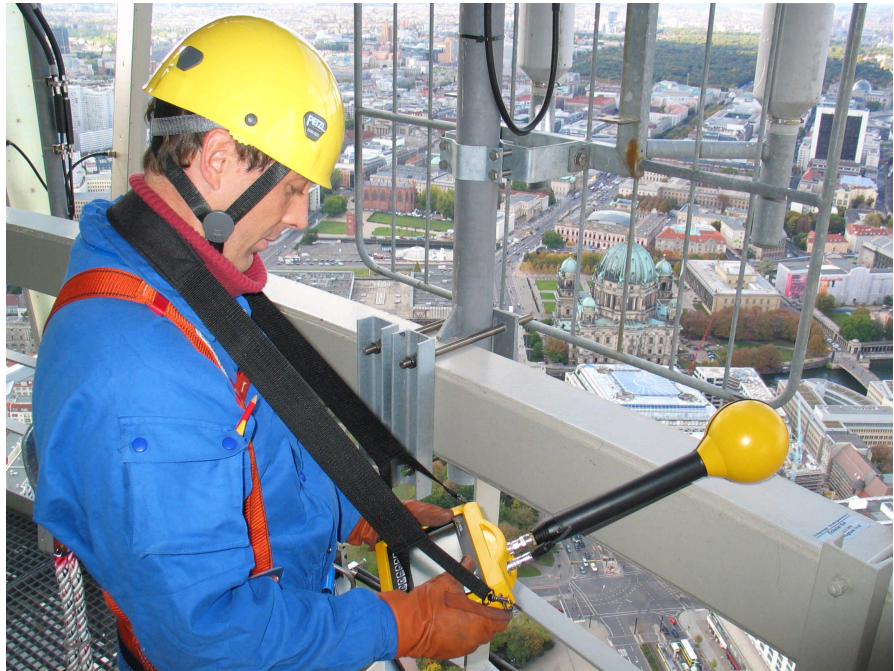
Medida del nivel de exposición de los trabajadores, en una torre de transmisión adyacente a unas antenas de radio digital (DAB).
