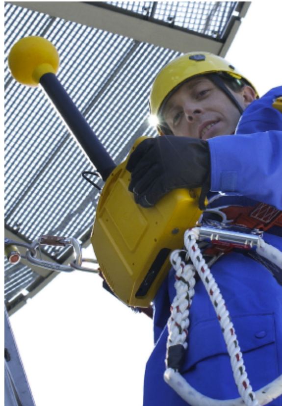
Bild 8: Messgerät und Sonde lassen sich zu einer Einheit verbinden und überall hin mitnehmen.
