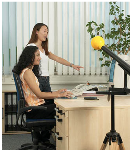
Messung der Feldexposition am Arbeitsplatz. Für die Abtastung eines Volumens lässt sich die Sonde auch in die Hand nehmen.
