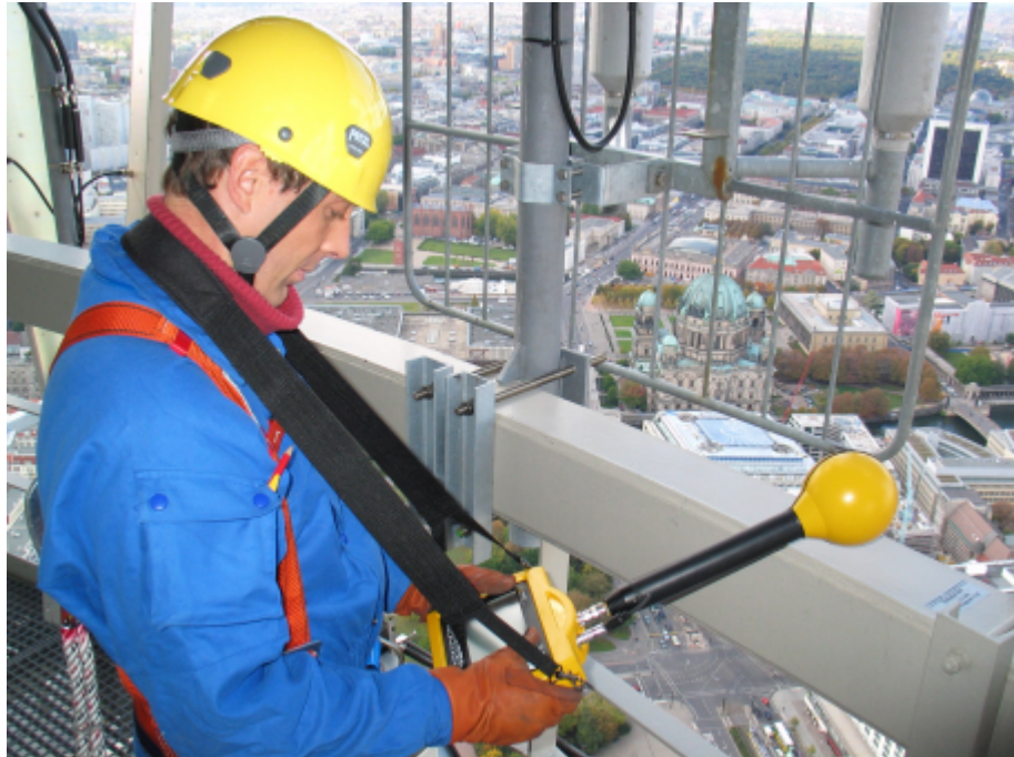
Messung der Feldbelastung von Mitarbeitern auf einem Sendeturm, hier in unmittelbarer Nähe von Antennen für den digitalen Rundfunk (DAB).
