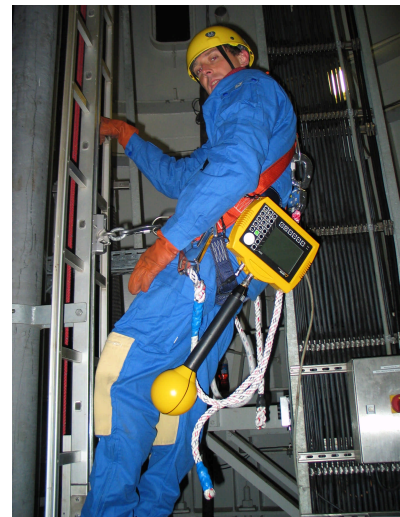
L'apparecchio base e la sonda si possono connettere in un'unica unità e possono essere portati con sé ovunque.
