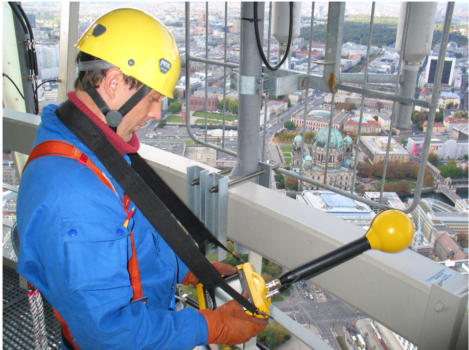
Dei collaboratori eseguono una misurazione del carico di campo su una torre di trasmissione, qui nelle immediate vicinanze di antenne per le onde radio digitali (DAB).
